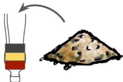
8. Coloque a ultima camada de brita e espalhe bem.
